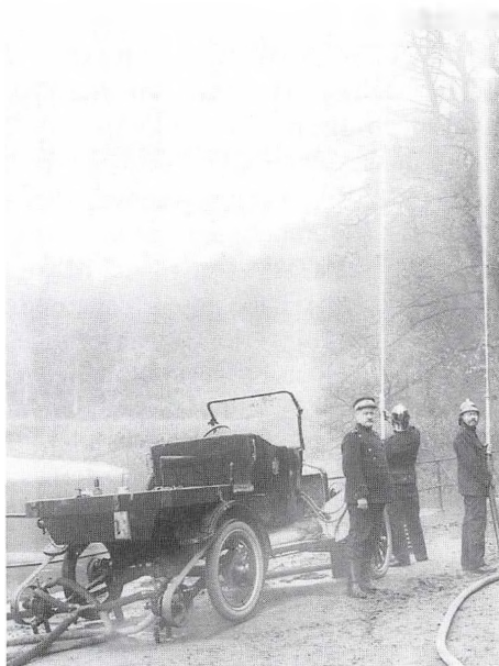
Ford T-vogn med to Ellehammer-pumper i funktion. Der er næppe tale om Lyngby Brandvæsens vogn, som var indrettet til transport af fire personer; men pumperne var af samme type.
