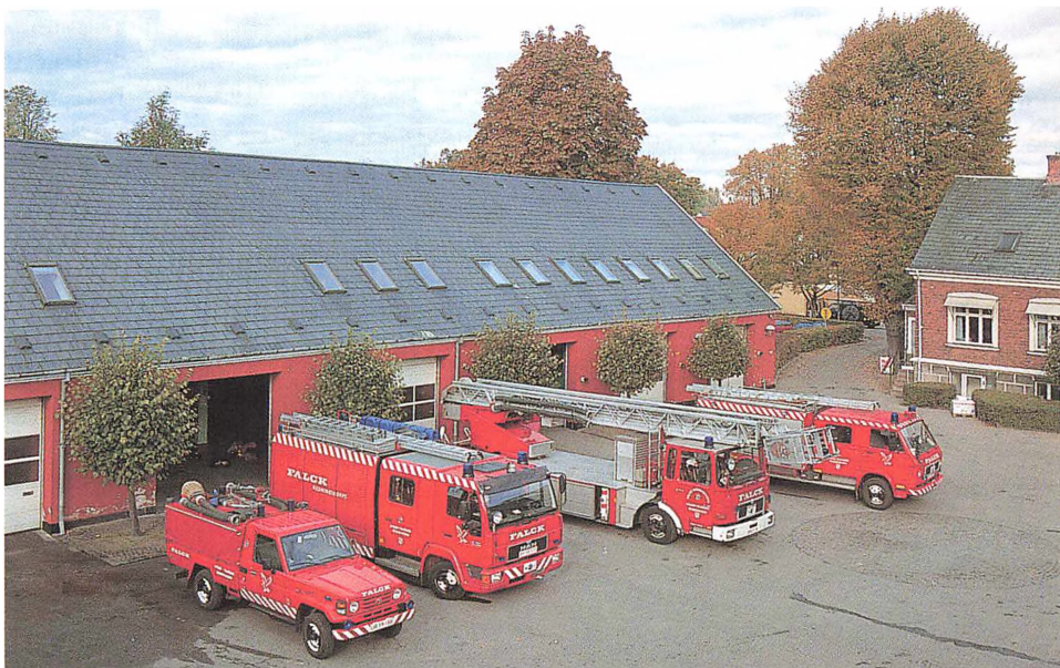
Lyngby Brandvæsens udrykningskøretøjer fotograferet i oktober 2003 fra en lånt drejestige. Fra venstre slangetenderen (2001), automobilsprøjte M1 (1998), drejestigen (1987) og M2 (1981). De to MAN-automobilsprøjter har 2000 liter/min. kombinerede høj- og lavtrykspumper fra Ruberg, 2000 liter vandtanke (M1 2600 liter) og 80 liter skumtanke samt hver 2 x 60 meter højtrykslange. Toyota-slangetenderen er forsynet med en 1500 liter/min. bærbar Tohatsu-sprøjte og 500 meter slange. Byhistorisk Samling
